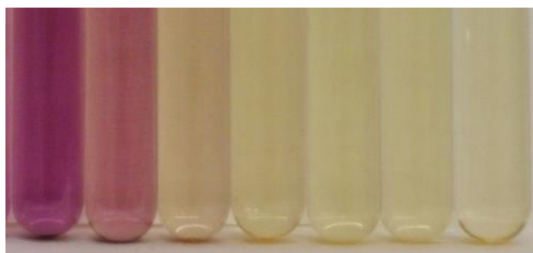
Figura 7 – Visualização da solução de DPPH após 1 hora no escuro com concentrações crescentes de extrato (da esquerda para a direita).
