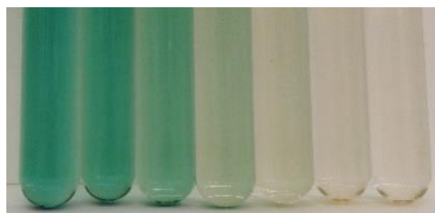
Figura 8 – Visualização da solução de ABTS com concentrações crescentes de extrato (da esquerda para a direita).
