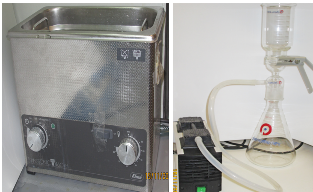
Figura 1 – Ultrassons Elma Transsonic 460 e sistema de filtração Phenomenex, acoplado a uma bomba de vácuo da Laboport, usando filtros de nylon (0,2 µm da Whatman).
