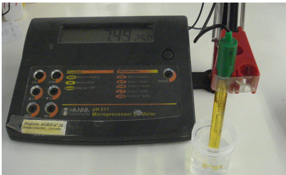
Figura 2 – Milivoltímetro usado na análise do pH em águas minerais
