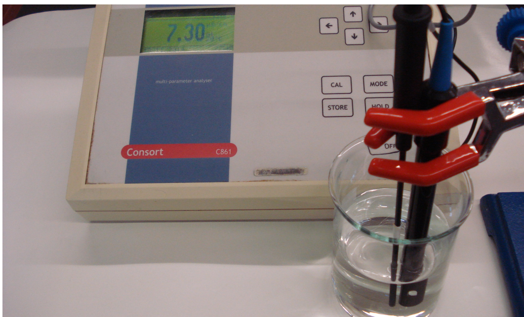
Figura 3 – Condutivímetro usado na análise da condutividade em águas minerais
