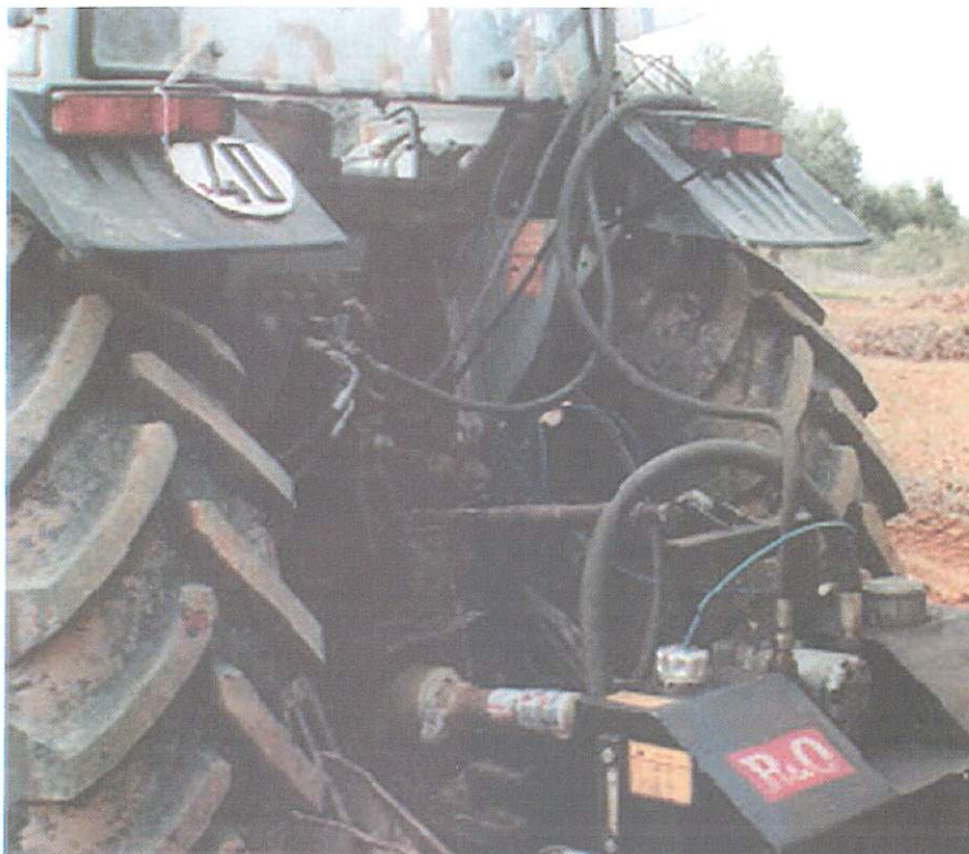
Fig. 14 - Bomba de óleo e depósito de óleo do vibrador.
