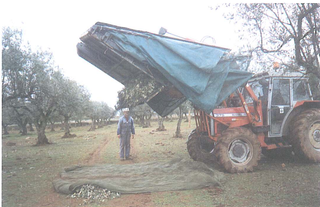
Fig. 21 - Alçapão de descarga do apara-frutos.
