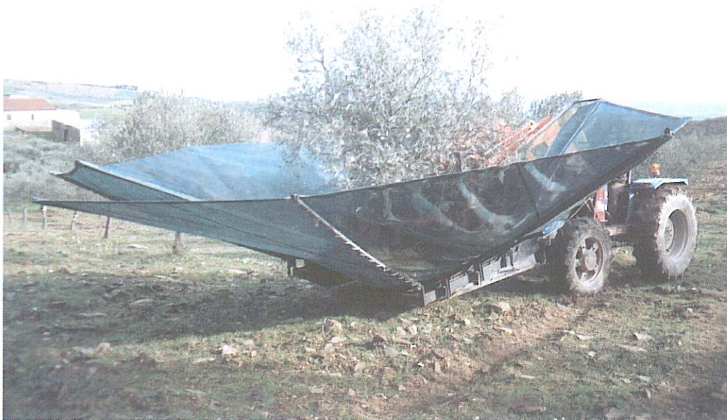
Fig. 20 - Aspecto geral do apara-frutos em trabalho, armado.
