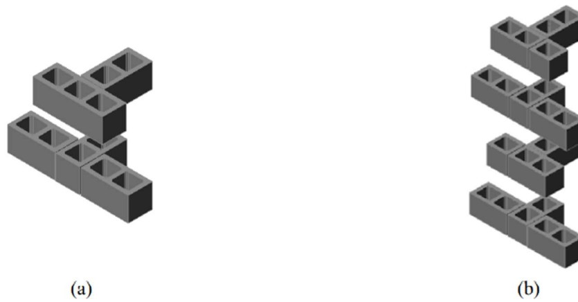
Figura 49 - Intersecção de paredes: (a) utilizando o bloco e meio e (b) utilizando o meio bloco (Haach et al., 2008).
