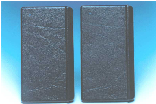
Figura 45 – Superfícies texturadas demasiado brilhantes.
