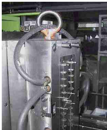
Figura 13 – Sistema de extracção molde 4 cavidades.
