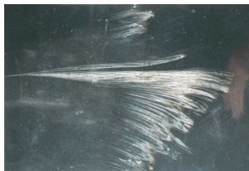
Figura 20 – Imagem de raiados provocados por gases no interior do molde.
