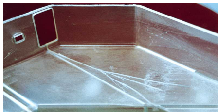
Figura 47 – Mostra uma peça partida durante a sua extracção.
