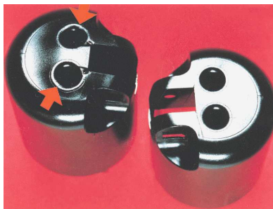
Figura 31 – Imagens que ilustram a deformação da peça durante a extracção da mesma.
