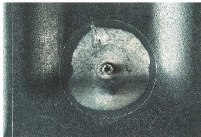
Figura 40 – Superfície mate junto aos bicos dos canais quentes.
