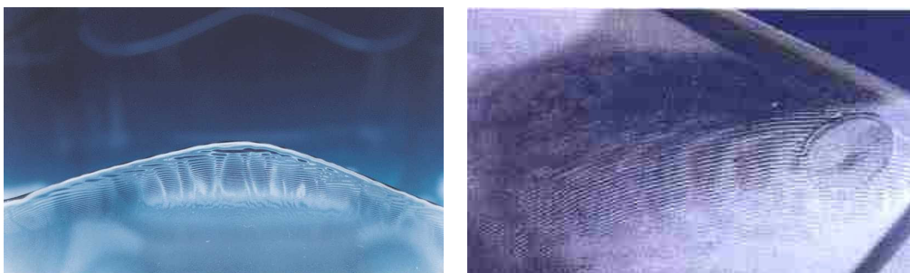
Figura 26 – Imagem de um efeito denominado de disco no material injectado.
