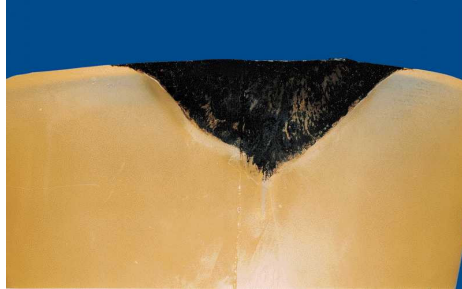
Figura 25 – Imagem de um queimado na peça plástica.
