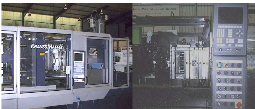
Figura 1 – Injectora com sistema de fecho nas colunas (à esquerda) e sem colunas (à direita).
