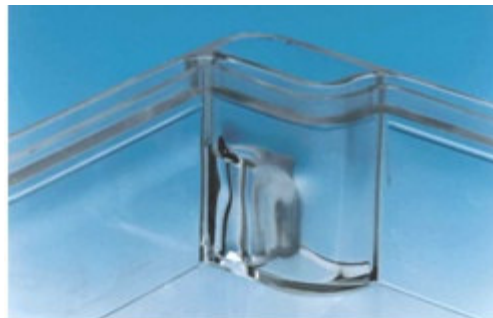
Figura 16 – Imagem de um chupado localizado
