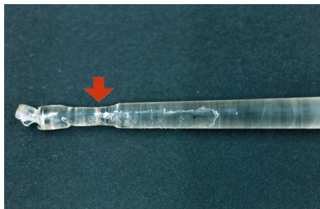
Figura 43 – Gito preso no injector.
