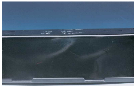
Figura 27 – Imagem que ilustra as marcas de tensões no material injectado.
