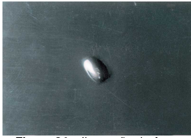
Figura 34 – Ilustração de Ar preso.
