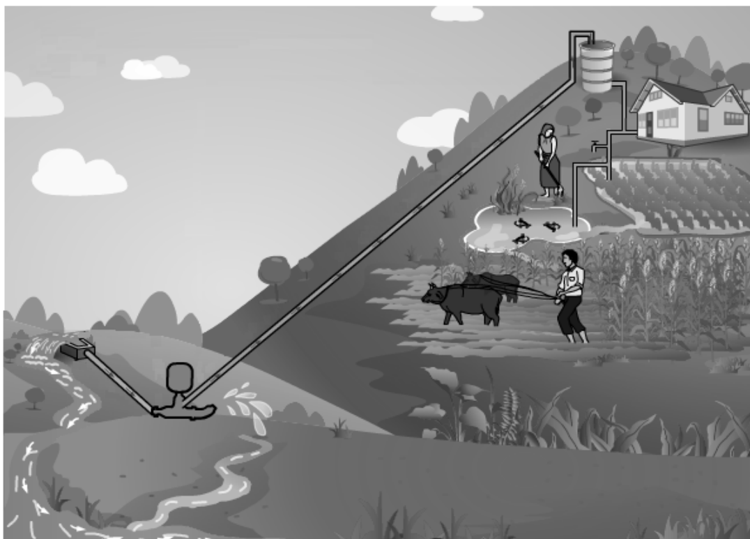
Figura 3.3 – Representação de uma utilização possível do carneiro hidráulico (Meribah Ram Pump, 2008).
