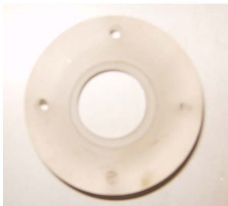
Figura 4.6 – Fotografia do anel de conexão entre tubagens para o diâmetro interior de 25 mm.
