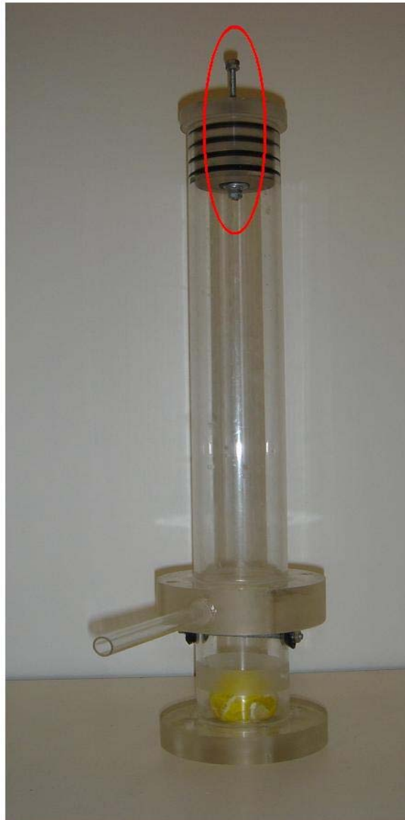
Figura 5.6 – Visualização da Válvula de entrega / câmara de ar número 3 com o pormenor do sistema para a libertação do ar existente.
