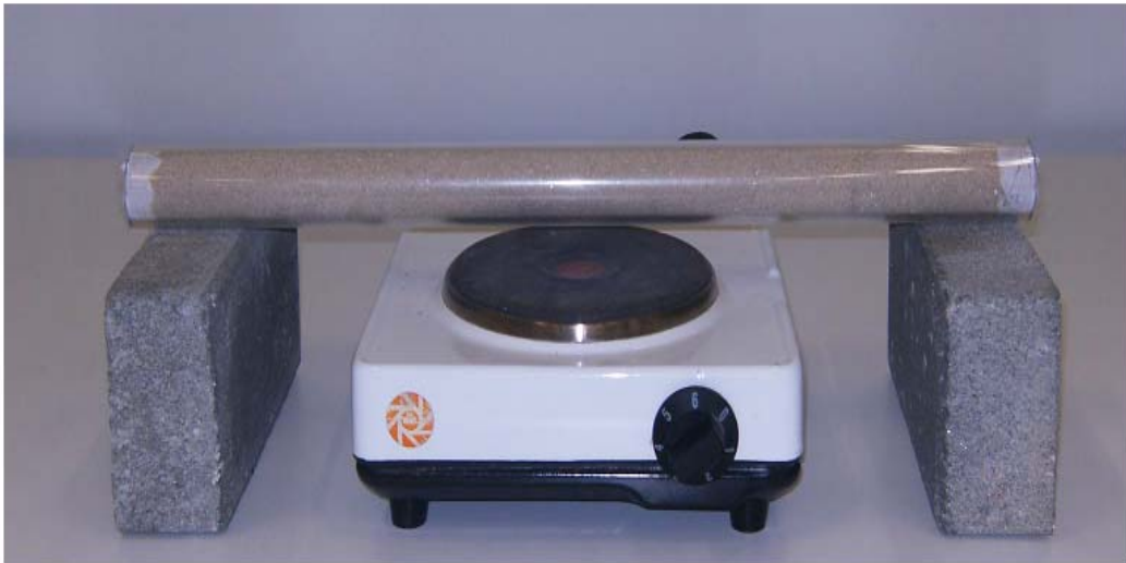
Figura 4.5 – Fotografia do procedimento para a execução da encurvadura de 40^\circ para o tubo de diâmetro de 25 mm.
