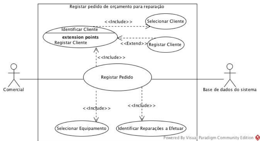
Figura 13 - Diagrama do Caso de Uso do Subsistema Registrar pedido de orçamento de reparação.
