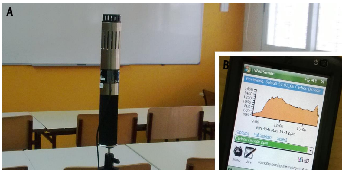
Figura 3.3 – Sonda DirectSense® IQ-610 (A) com conexão para PDA Socket® SoMo 650-DX (B).
