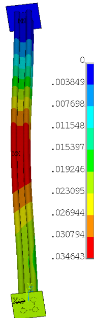
Figura C.90: Soma do Vetor de Deslocamento para HB com Fator de Carga de 30 %, Comprimento de 6 m, Espessura de 3,1 mm e ISO 834
