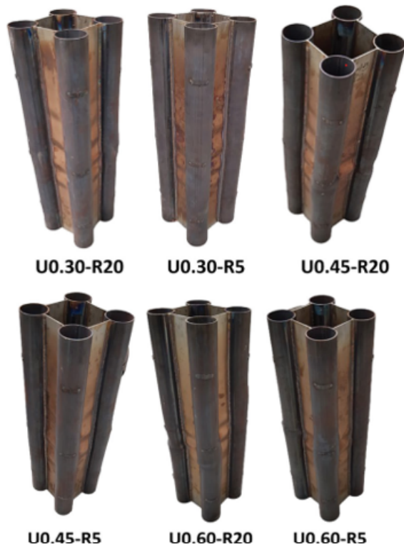
Figura 4.30: Modos de colapso experimental das colunas Híbridas [35]
