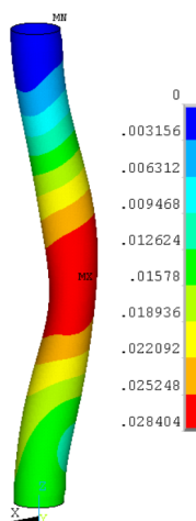
Figura B.29: Soma do Vetor de Deslocamento para CHS com Fator de Carga de 40 %, Comprimento de 0,78 m, Espessura de 6 mm e R20
