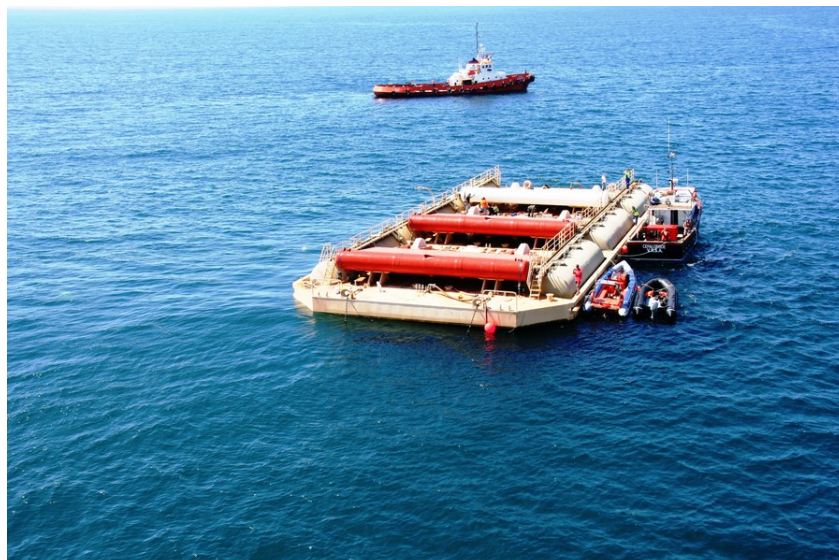
Figura 1.3: Conversores Oscilantes de Translação das ondas, (PortalEnergia 2016).
