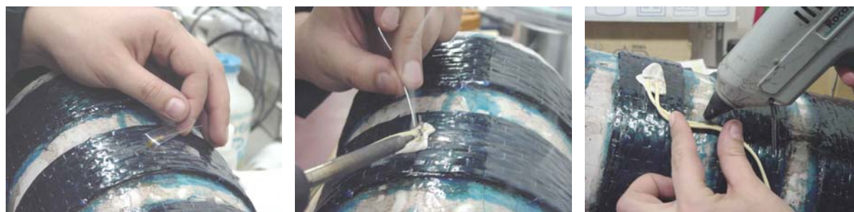
Aplicação do extensómetro
