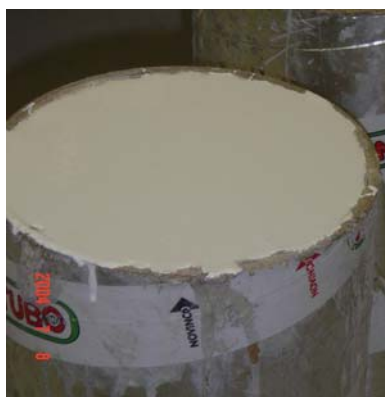
Aspecto final do provete rectificadado
