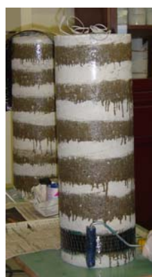
Impregnação completa da resina
