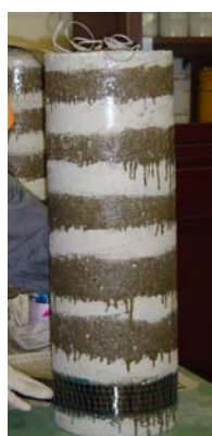
Aplicação da faixa de CFRP
