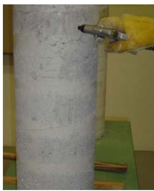
Limpeza com ar comprimido
