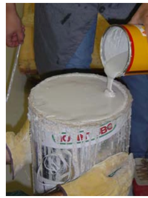
Aplicação do Icosit aos provetes
