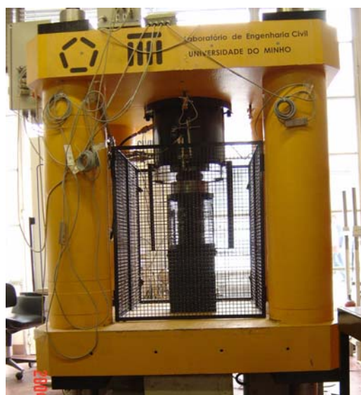
Figura 3.7 – Bastidor de ensaios à compressão uniaxial utilizados nos grupos de ensaios C23S200, C16S200 e C16S300, e nos restantes provetes da 2ª e 3ª fases do programa experimental.
