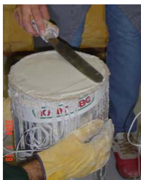
Aplicação do Icosit aos provetes
