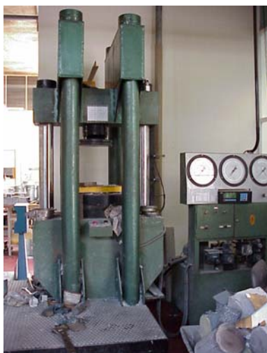
Figura 3.6 – Prensa de compressão uniaxial utilizada no grupo de ensaios C23S300.
