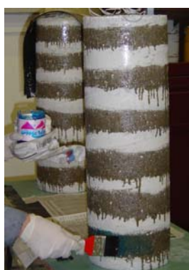
Aplicação da resina
