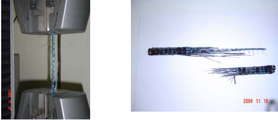
Figura 2.7 – Aspecto do provete de CFRP após ter sido ensaiado.
