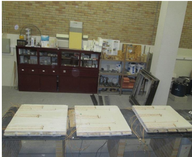
Figura 33 - Modelos de parede em tabique instrumentados.
