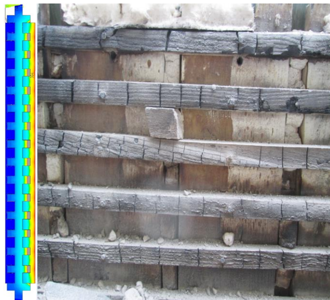
Figura 82 – Resultado final numérico e experimental dos danos no material ensaiado.
