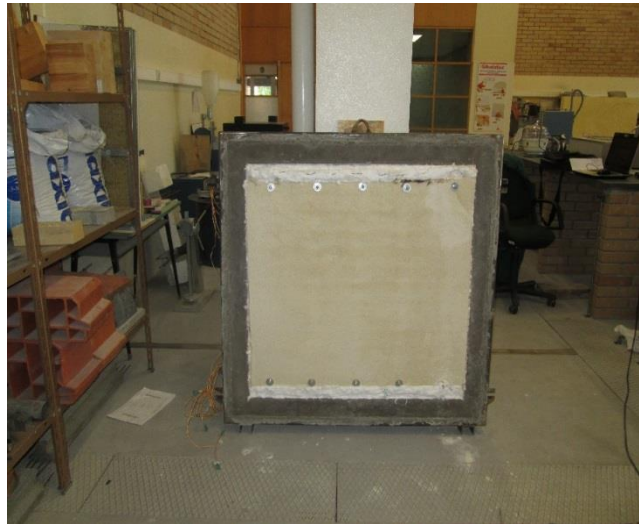
Figura 36 – Parede instalada no aro de fixação.
