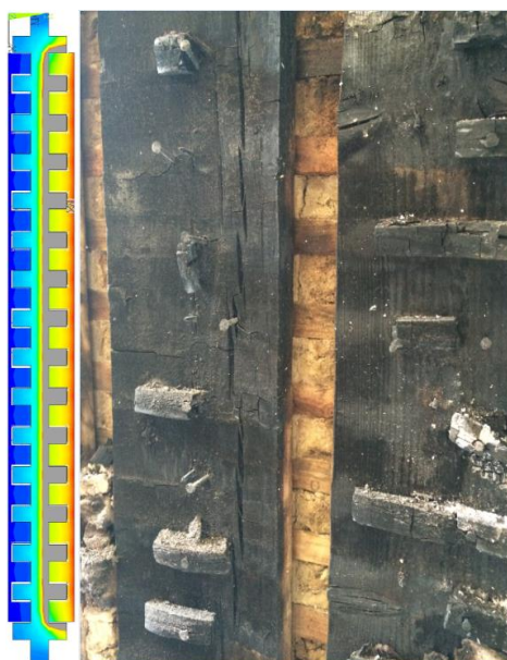
Figura 86 – Resultado final numérico e experimental dos danos no material ensaiado.
