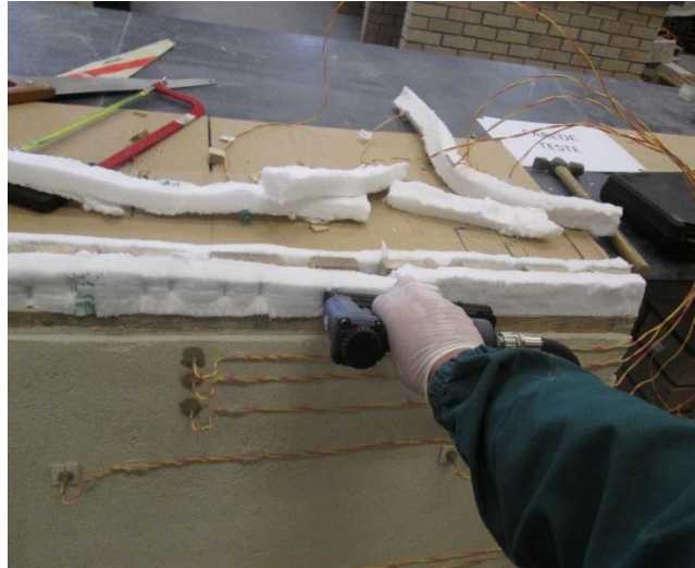
Figura 35 – Isolamento nos contornos do modelo de parede.
