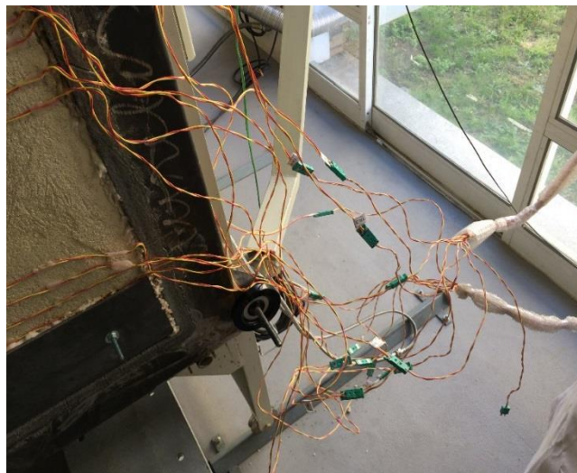
Figura 38 – Ligação das fichas às extensões do MGC Plus.
