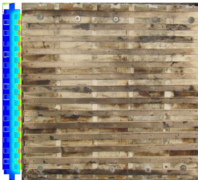
Figura 90 - Resultado final numérico e experimental dos danos no material ensaiado.
