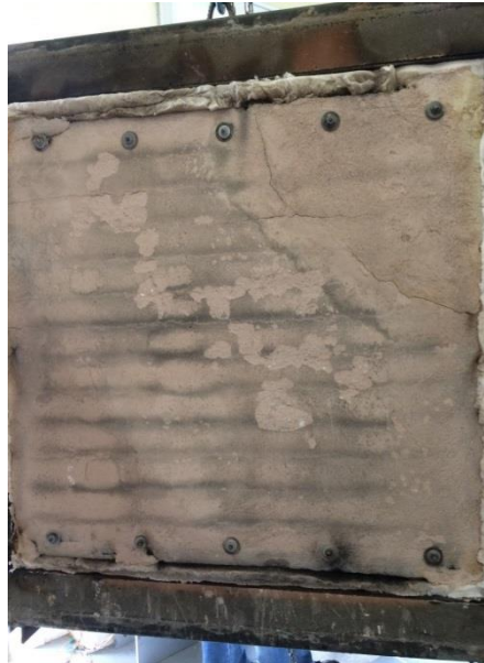
Figura 48 – Resultado da Parede II após o ensaio.
