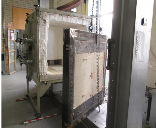
Figura 37 – Acoplamento do modelo de parede em tabique ao forno de ensaio.
