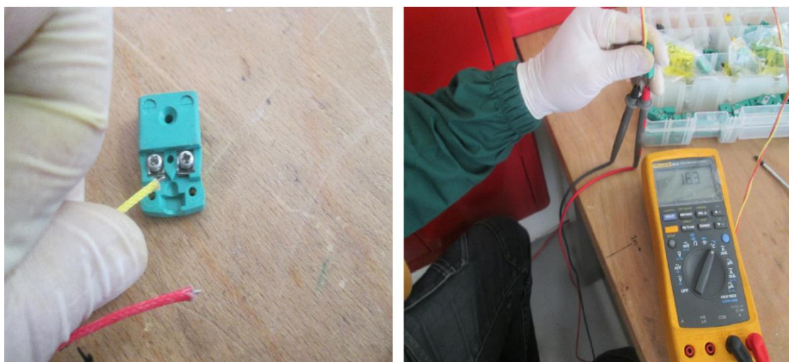
Figura 32- Ligação dos termopares às fichas e verificação de funcionamento.
