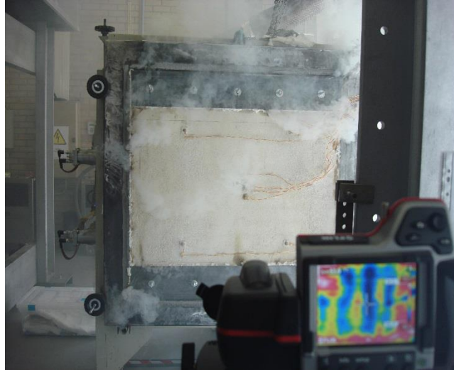
Figura 44 – Liberação de fumo durante o ensaio de resistência ao fogo.
