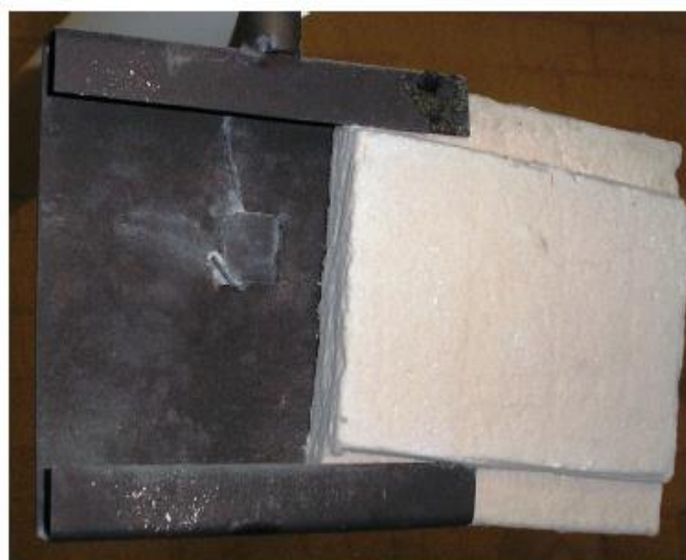
Figura 5 – Pormenor da placa de um termopar [17].
