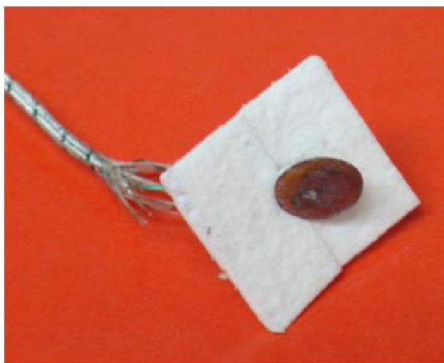
Figura 6 – Exemplo de união de um termopar de superfície e a placa de isolamento [17].
