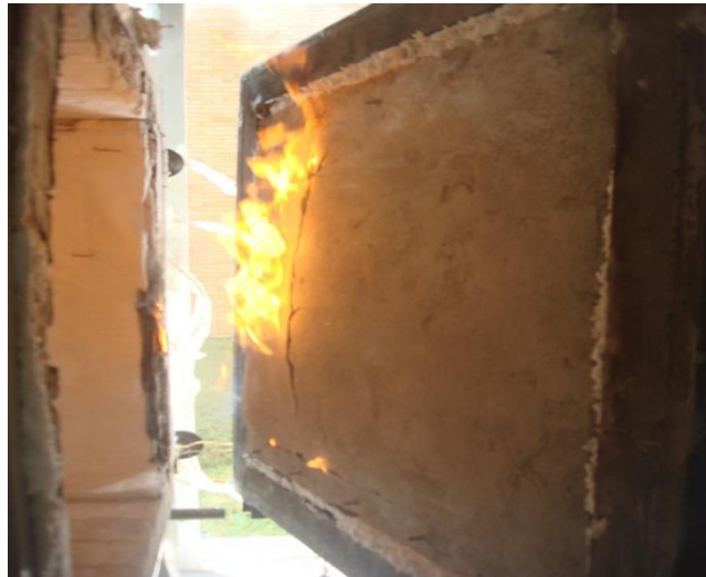
Figura 46 – Libertação da chama proveniente da combustão da madeira.
