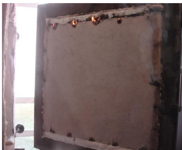
Figura 42 – Término do ensaio ao fogo da Parede Teste.
