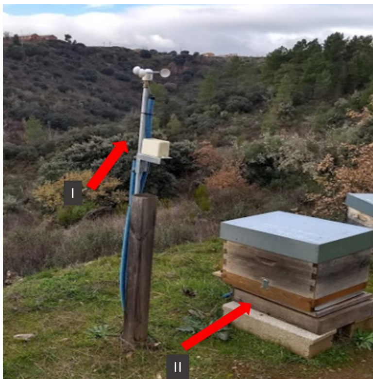
Figura 7: I – Estação meteorológica e II – balança automática instalada no apiário na aldeia de Gimonde.
