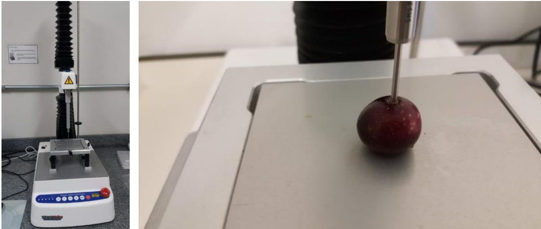
Figura 5 – Texturómetro, TA.XT. Textura plus (Stable Microsystems, Godalming, Reino Unido), realização da análise da textura em uma azeitona.
