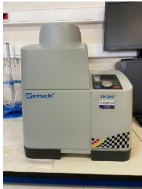
Figura 4 - Moinho de laboratório utilizado na trituração do caroço de azeitona.
