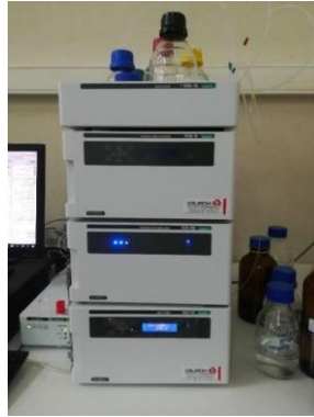
Figura 3 - Sistema de HPLC-DAD (Jasco Extreme) utilizado na quantificação da sertralina.
