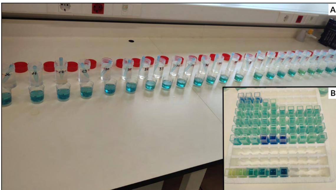
Figura 14: Desenvolvimento de cor pelo método do fenato para determinação de ião amónio.
