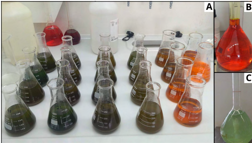
Figura 13: Imagem A: preparo das soluções de solo com 1 g de terra + 10 ml dicromato de potássio + 20 ml ácido sulfúrico + 200 ml de água destilada. Imagem B: solução de dicromato de potássio (49,04 g de K_2Cr_2O_7 + 1000 ml de água destilada). Imagem C: solução de 0,5N Fe^{++} (196,1g Fe(NH_4)_2(6H_2O) + 800 ml de água destilada com 20 ml H_2SO_4 concentrado).
