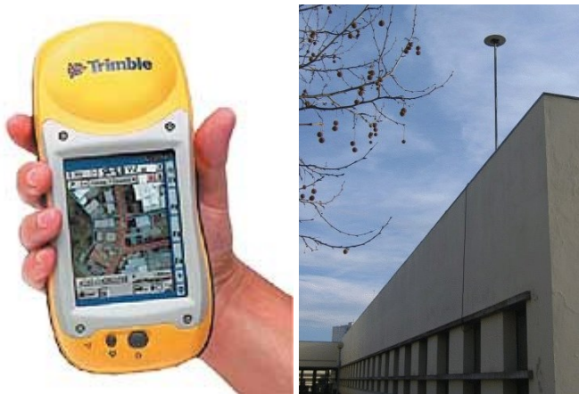
Figura 27 - Receptor GPS Trimble GeoXT: Sistema Operativo Microsoft Windows Mobile para Pocket PC e software TerraSync (esquerda). Antena da estação base de referência do IPB: Receptor: Trimble Pathfinder Pro XR. Software: TRS – Trimble Reference Station (direita)
