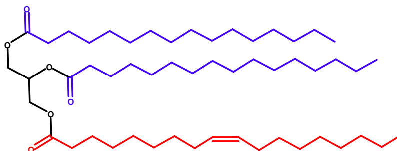
Figura 4. Exemplo ilustrativo da estrutura de um triglicérido. A azul – Ácido palmítico (C16:0); A vermelho – Ácido oléico (C18:1n9). (Fonte: Elaboração própria através do programa ChemSketch Freeware 14.0).
