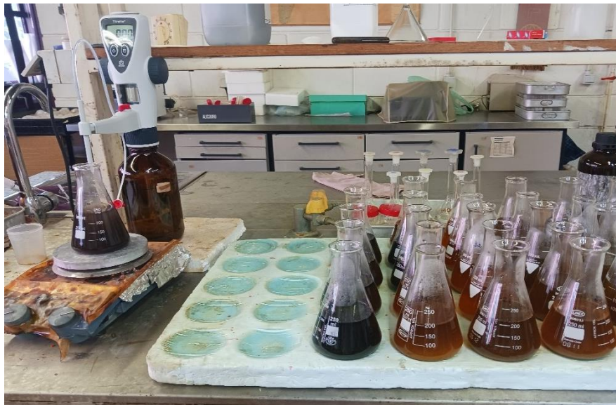
Figura 12- Determinação da matéria orgânica pelo método Walkley-Black.
