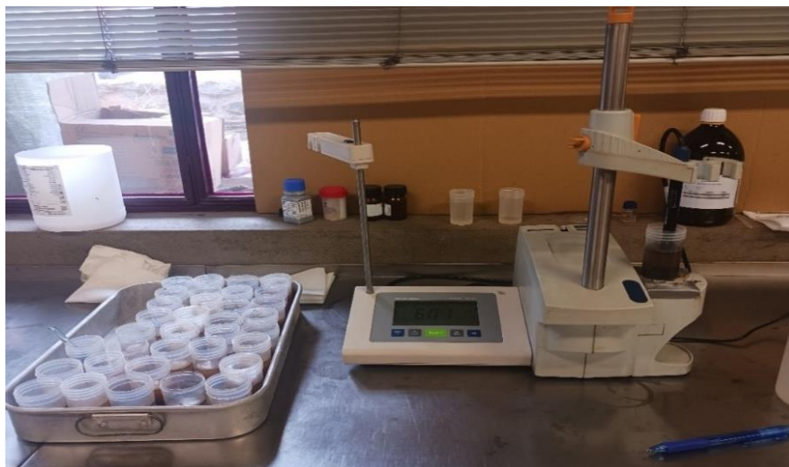
Figura 13- Leitura do pH (Potenciômetro Mettler Toledo)
