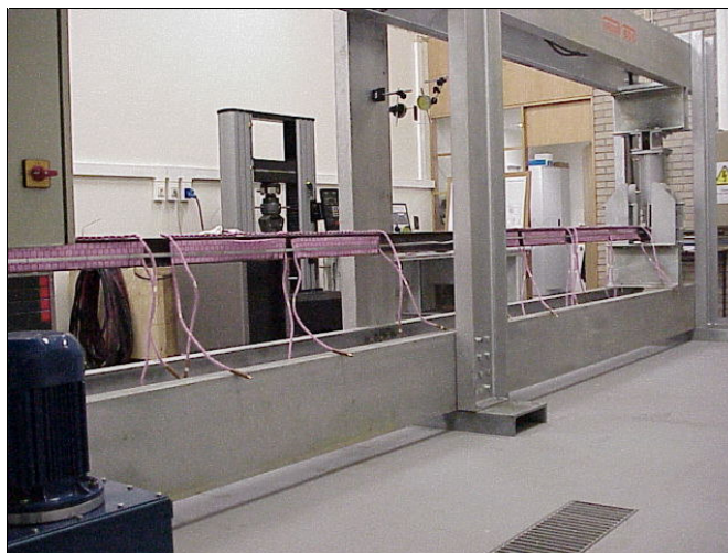
Fig. 8.25 – Pórtico de reacção para ensaios estruturais.
