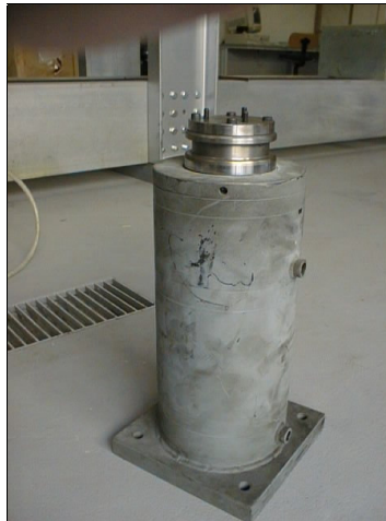
Fig.8.32 - Actuador de duplo efeito até 60 [ton].
