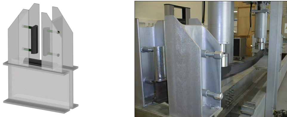
Fig.8.27 - Implementação de apoios simples de forquilha na estrutura.
