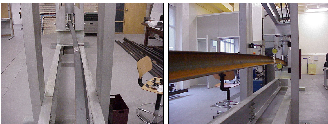
Fig. 8.46 – Encurvadura de duas vigas com 4.5 e 5.5 [m] à esquerda e direita, respectivamente.
