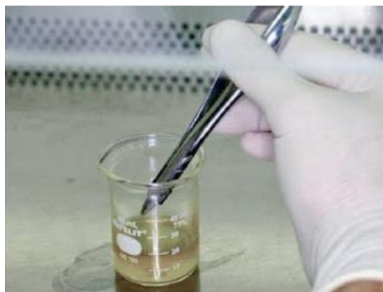
Figura 11- Desinfecção de um produto médico com álcool etílico a 70% [30].
