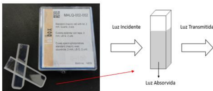
Figura 3.11: Ilustração fotográfica das células de quartzo utilizadas na análise das amostras em estudo assim como um esquema ilustrativo da incidência de luz sobre a amostra.
