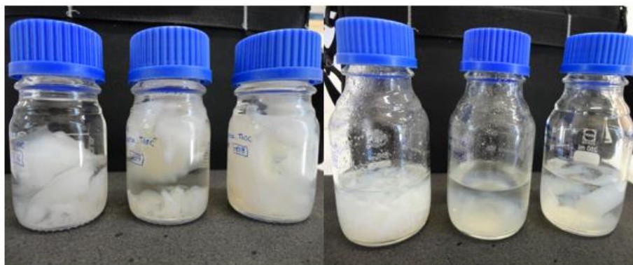
Figura 7.1: Ilustração fotográfica do processo de libertação de DNA imobilizado internamente a partir dos hidrogéis HG16 a HG21, respetivamente. A comparação visual dos frascos permite avaliar de forma simples a estrutura (colapso/inchamento) dos hidrogéis quando colocados em meios com diferente pH.
