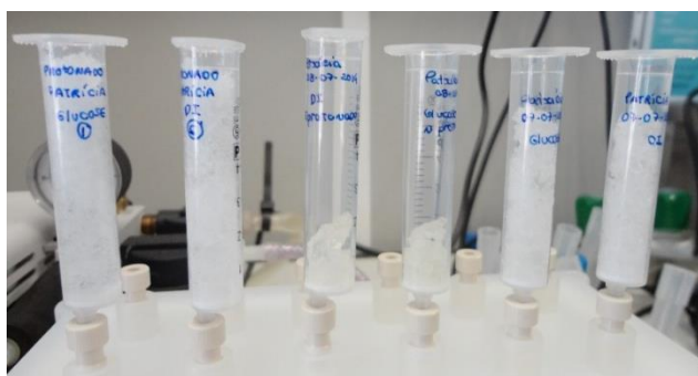
Figura 7.8: Ilustração fotográfica das diferentes etapas do estudo em SPE. Primeiramente observa-se as soluções de baixa concentração (Teste 1 e 6) com o hidrogel protonado, seguidamente as soluções de elevada concentração (Teste 4 e 9) com hidrogel não protonado e protonado, respetivamente.
