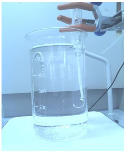
Anexo 56: Ilustração fotográfica do processo de borbulhamento do monômero com argônio durante a polimerização. Desta forma, realiza-se a remoção de O_2 (que funciona como inibidor) de modo a manter o meio reacional desgasificado.
