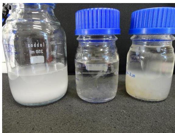
Figura 6.3: Ilustração fotográfica do processo de libertação dos hidrogéis HG12 (termossensível), HG13 (aniónico) e HG14 (catiónico) quando colocados a 40 °C, numa solução aquosa a pH=10 e pH=2, respetivamente.
