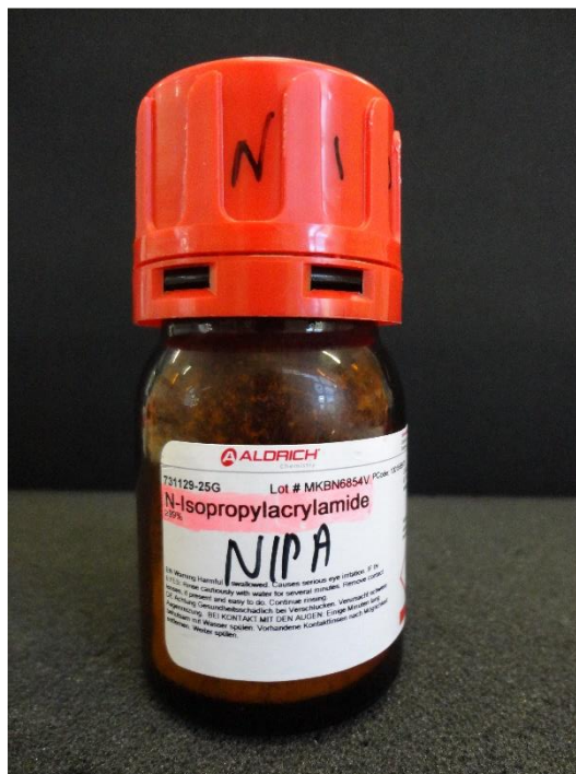
Anexo 53: Ilustração fotográfica do monómero NIPA. Monómero utilizado na síntese de hidrogéis sensíveis à temperatura. Produto adquirido à Sigma Aldrich.
