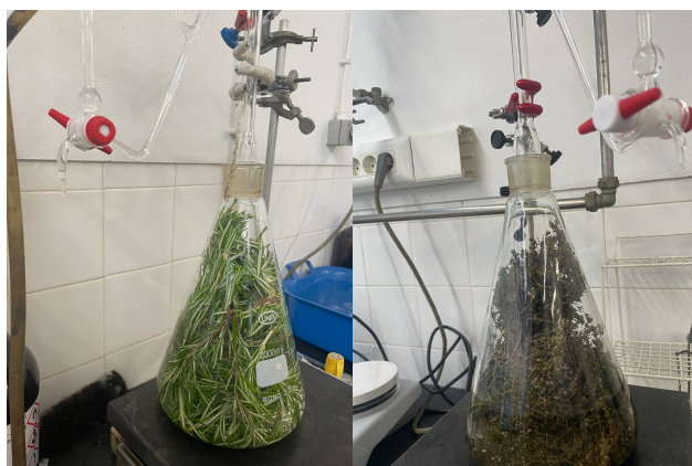
Figura 11. Extração dos óleos essenciais de Rosmarinus officinalis e Thymus zygis zygis através do aparelho de Clevenger.
