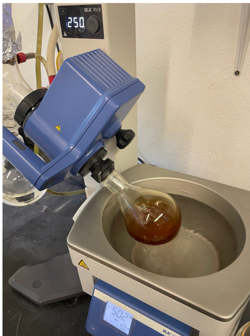
Figura 9. Processo de evaporação rotativa do solvente de extrato borra de café
