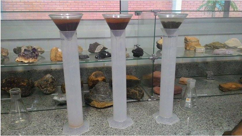
Figura 8. Início do processo de infiltração e retenção de água no solo.
