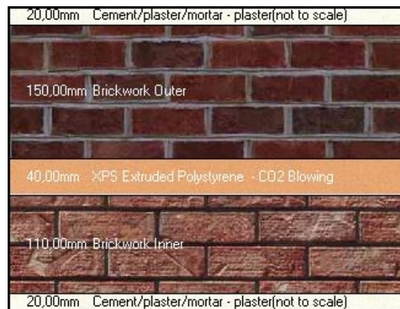
Figura 6.4 – Constituição da parede externa DB
