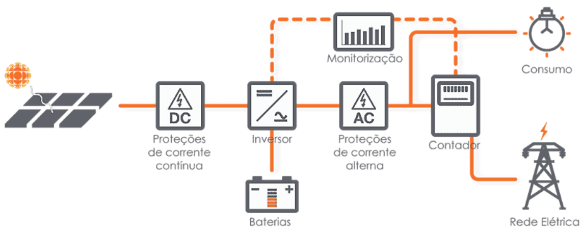
Figura 7.1 - Esquema genérico de funcionamento de uma UPAC [11]
