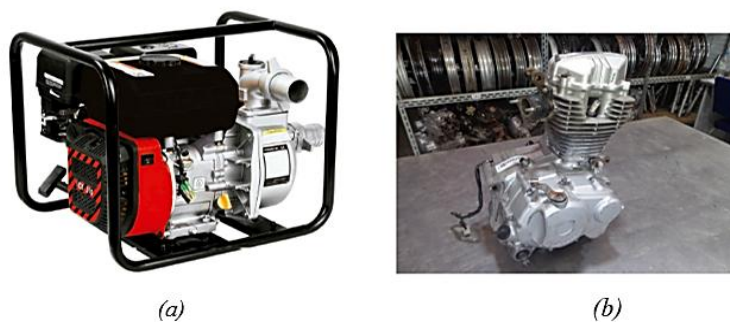
Figura 11 - Equipamentos a serem abastecidos pelo gaseificador: (a) Motobomba Campeon MRX-50 , (b) Motor de uma CG-125 Titan .
