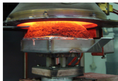
Fig 1 - Desenvolvimento da intumescência durante ensaio.
