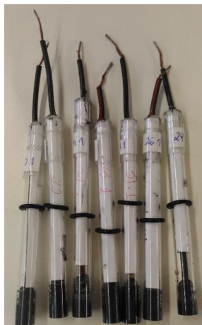
Figura 7. Imagem dos elétrodos de trabalho construídos
