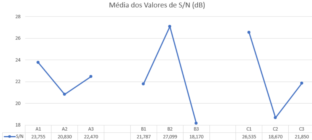
Figura 4.10: Curva S/N médio de cada parâmetro para o limite de resistência à flexão das juntas recozidas.
