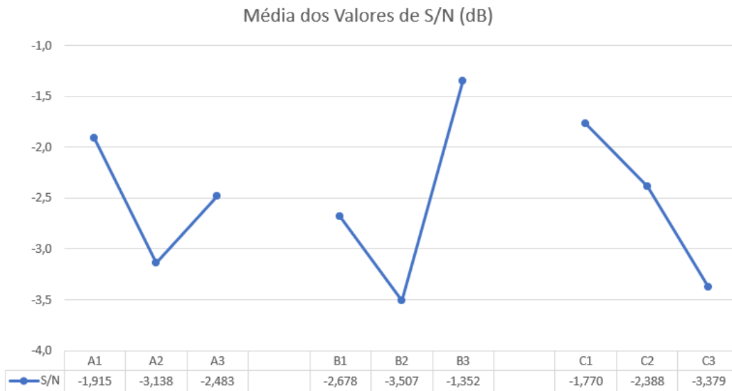
Figura 4.2: Curva S/N médio de cada parâmetro para o reforço das juntas recozidas.
