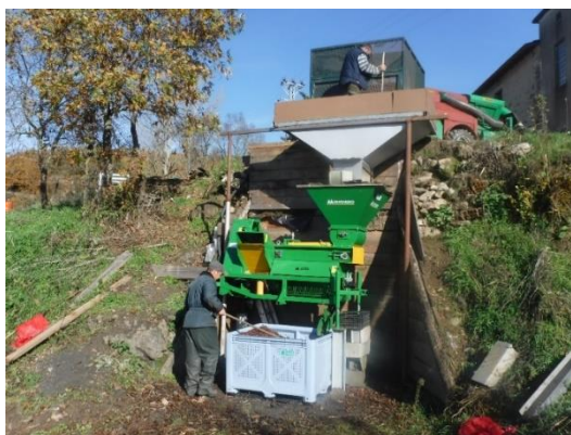
Figura 5 - Equipamento de limpeza e desouraçamento em armazém Monchiero 400.
