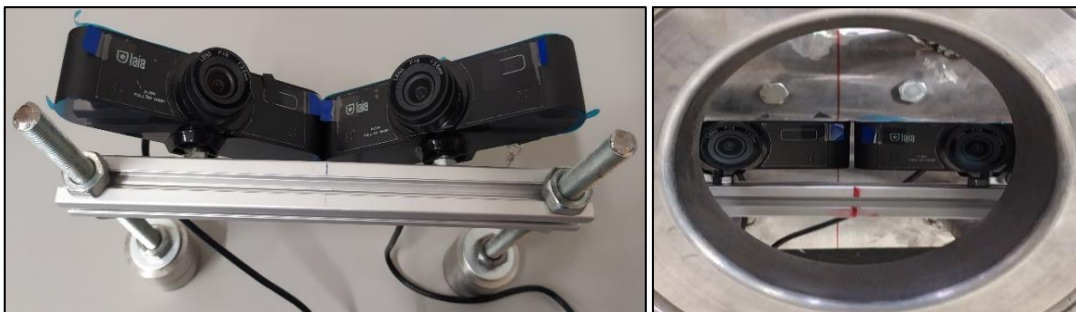
Figura 69 – Suporte e posicionamento das câmeras.
