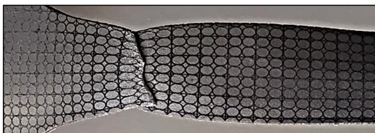
Figura 81 – Fratura geometria 20mm (1.4512 – amostra 2).
