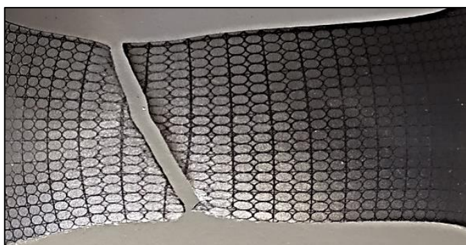
Figura 82 – Fratura geometria 40mm (1.4512 – amostra 2).
