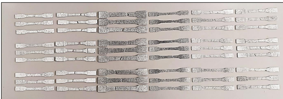
Figura 33 – Corpos de prova após os ensaios de tração.
