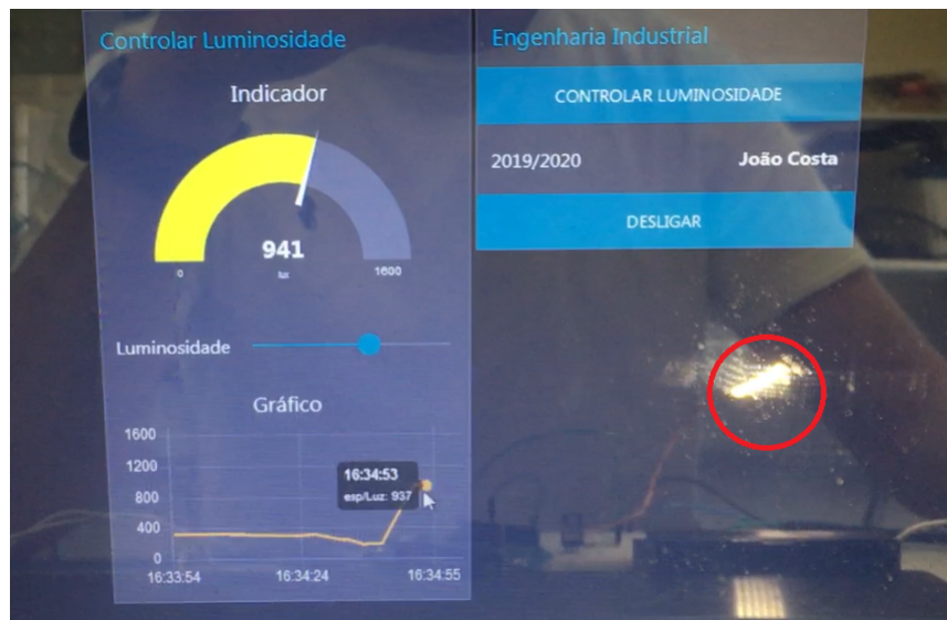
Figura 5.6: Início do controlo de luminosidade.
