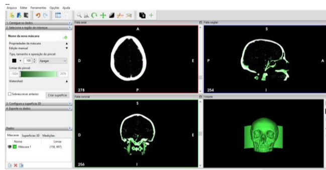
Figura 15 Ambiente de trabalho do Invesalius, com a aplicação do threshold , em que este abrange a parte óssea da TC.
