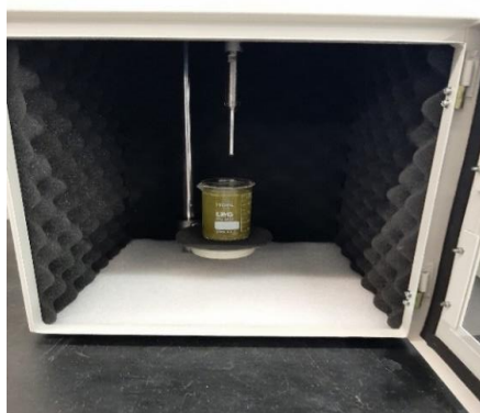
Figura 5. Extração assistida por ultrassons do alecrim
