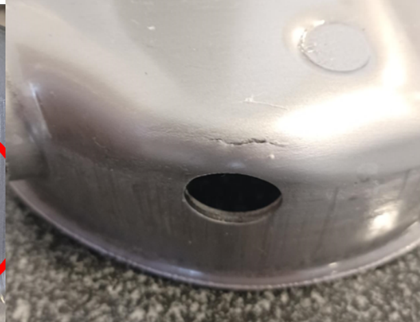
(d) Crack next to the hole
