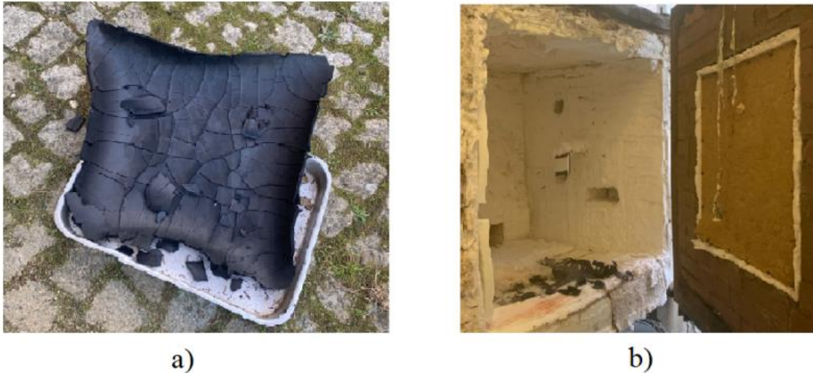
Figura 5.4: a) Carbonização completa da placa de MDF ao fim do ensaio no forno, b) Interior do forno após o ensaio.
