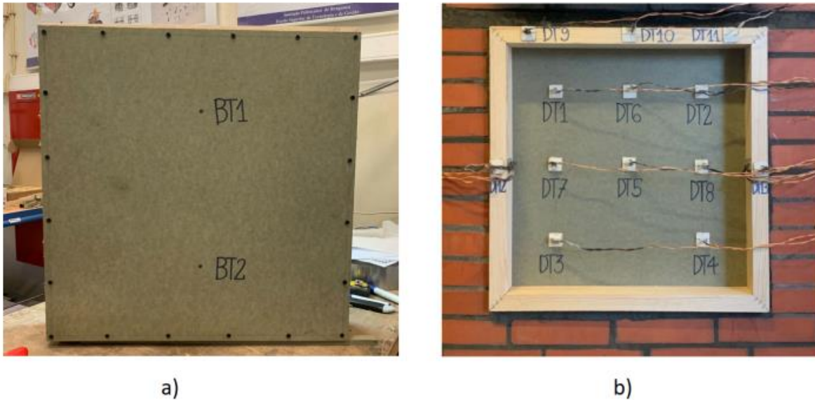
Figura 4.3: Modelo de MDF ensaiado: a) Lado exposto; b) lado não exposto instalado na estrutura do forno, com paredes de tijolos e aro de pinho, [15].
