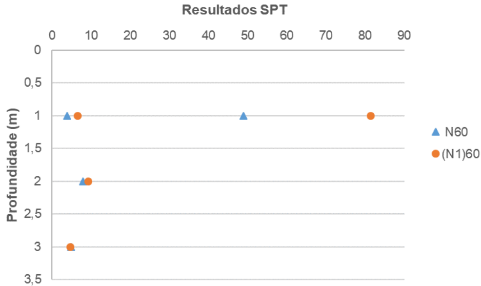
Figura 23- Distribuição em profundidade dos valores N_{60} e (N_1)_{60} , do ensaio SPT, do campo experimental 4
