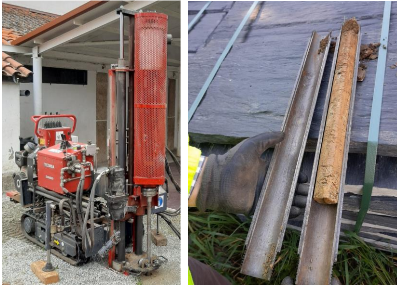
Figura 16- Penetrômetro dinâmico portátil do Laboratório de Geotécnica do Instituto Politécnico de Bragança e amostrador do ensaio SPT.
