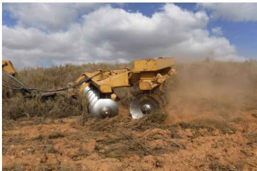
Figuras 4.1 e 4.2 – Regularização superficial do solo com grade de discos. Regularización superficial del suelo con grada de discos.
