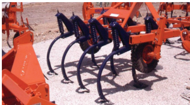
Figura 4.5 – Chisel para preparação do solo sem inversão de leiva. Chisel para preparación del suelo sin inversión de horizontes.
