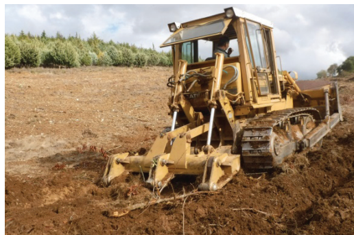
Figuras 4.3 e 4.4 – Subsolação ou ripagem. Subsolado o ripado.
