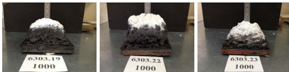
Figura 7: Expansão das amostras ensaiadas no calorímetro de cone.
