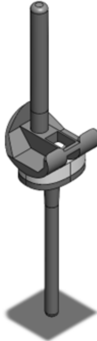
Figura 16- Modelo 3D da prótese utilizando o SolidWorks®.
