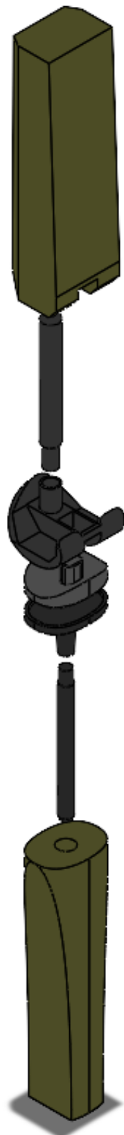
Figura 17- Modelo do conjunto osso-prótese, utilizando o SolidWorks®.
