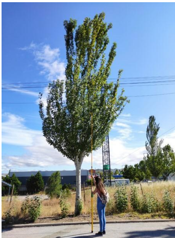
Figura 5 – Vara graduada utilizada para medir a altura das árvores
