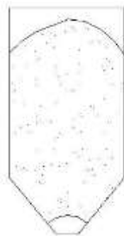
Figura 22: Obstrução em Abóboda
