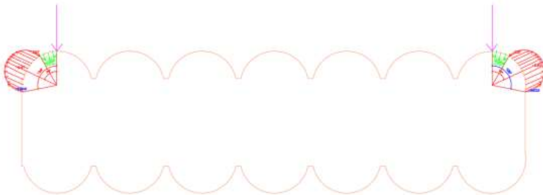
Figura 71: Distribuição da pressão nas células verticais de bordo (fachada ventilada)
