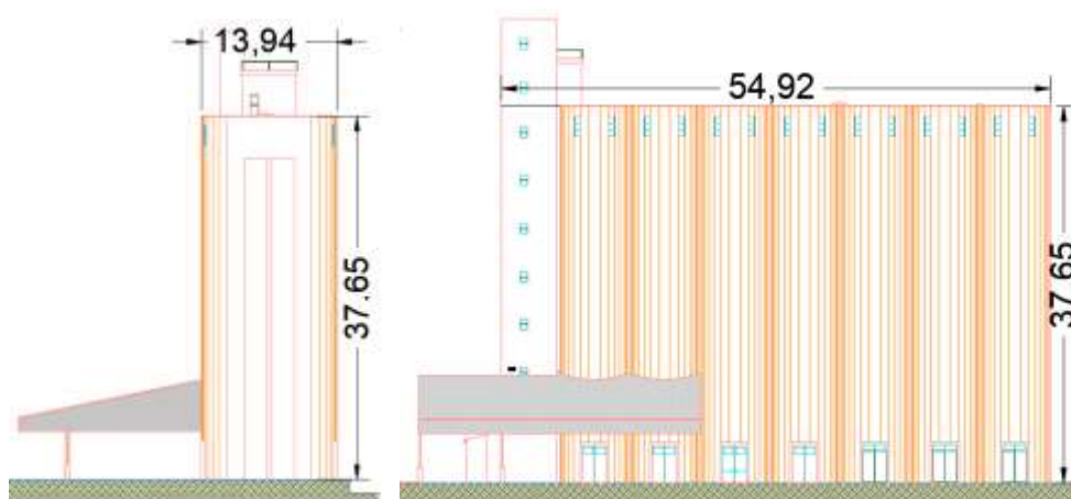
Figura 47: Medidas (b;d) para quando o vento for perpendicular à fachada opaca
