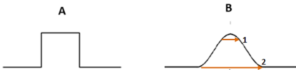
Figura 39 - Perfis do laser. A – Perfil desejado; B - Perfil gaussiano normalmente obtido através do laser.
