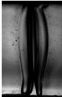
Figura 58 - Rasgo obtido com o Power (25) e Speed (0.4).
