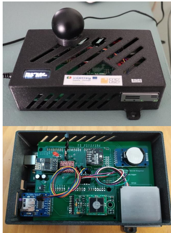
ilustración 16 – Ensamblaje final de la caja de monitoreo desarrollada por IPB
