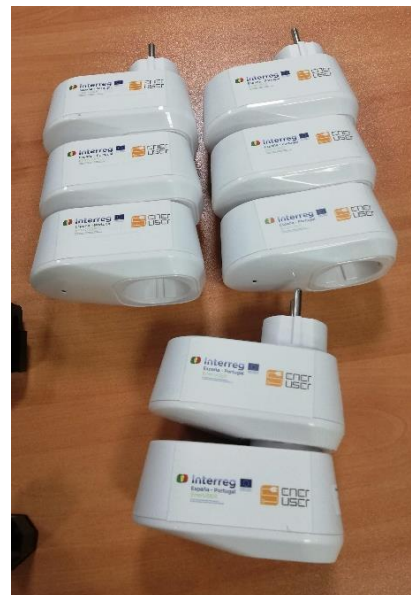
Ilustración 3: Dispositivos para medición de consumos eléctricos
