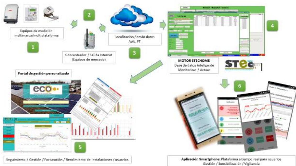
Ilustración 25: Estructura general del sistema
