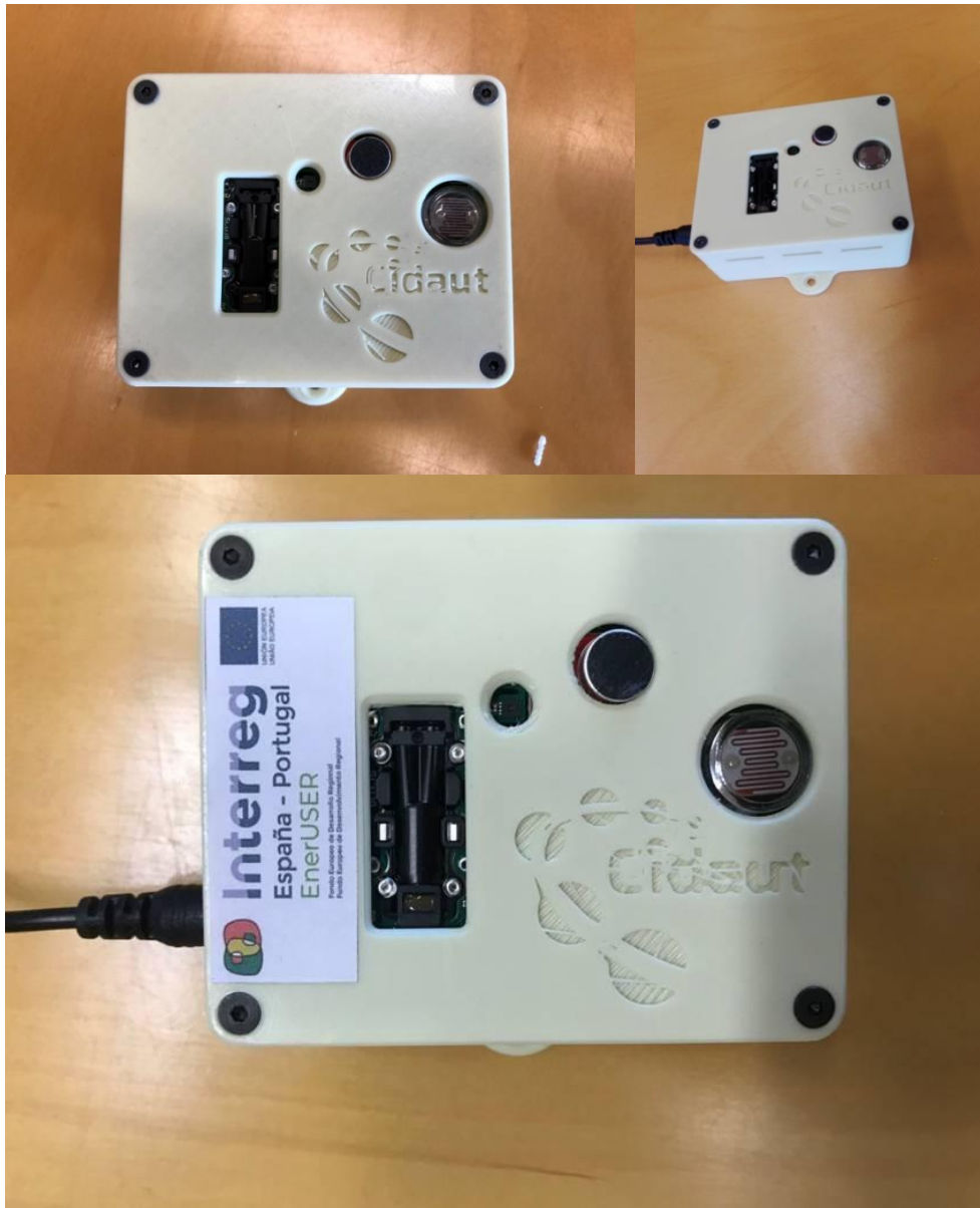
Ilustración 9: Vista del sensor de confort interior en de su carcasa
