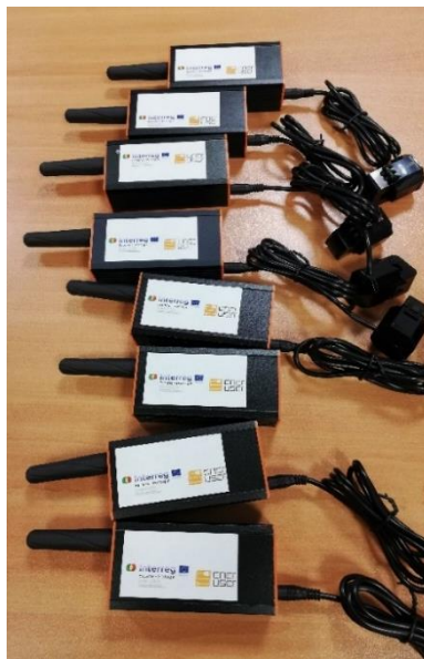
Ilustración 3: Dispositivos para medición de consumos eléctricos
