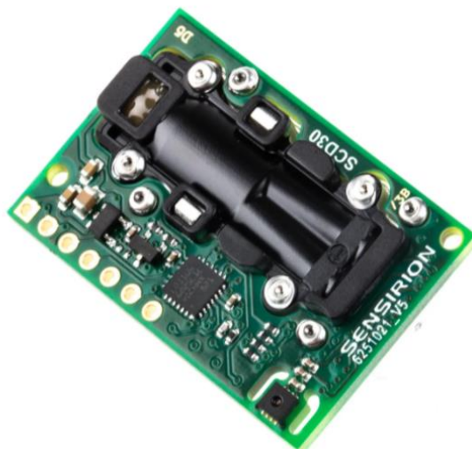
Ilustración 5: Sensor de temperatura, humedad y CO 2 Sensirion SCD30
