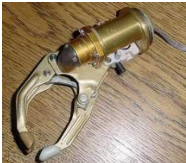
Figura 12: Prótese ativa mioelétrica da empresa OttoBock; (Ottobock, 2019).
