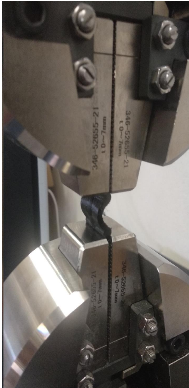
Figura 30: Ensaio de compressão de uma das juntas flexíveis.
