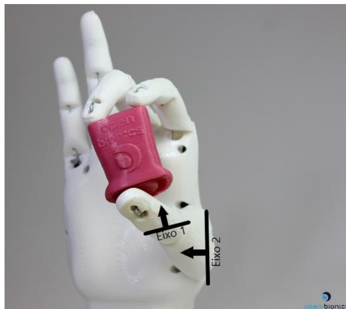
Figura 34: Ângulo entre os eixos da prótese Ada Robotic Hand V1.1, Adaptado de (Open Bionics, 2020).
