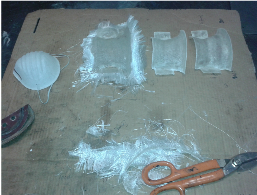
Figura 3.18: Peças após separação do molde
