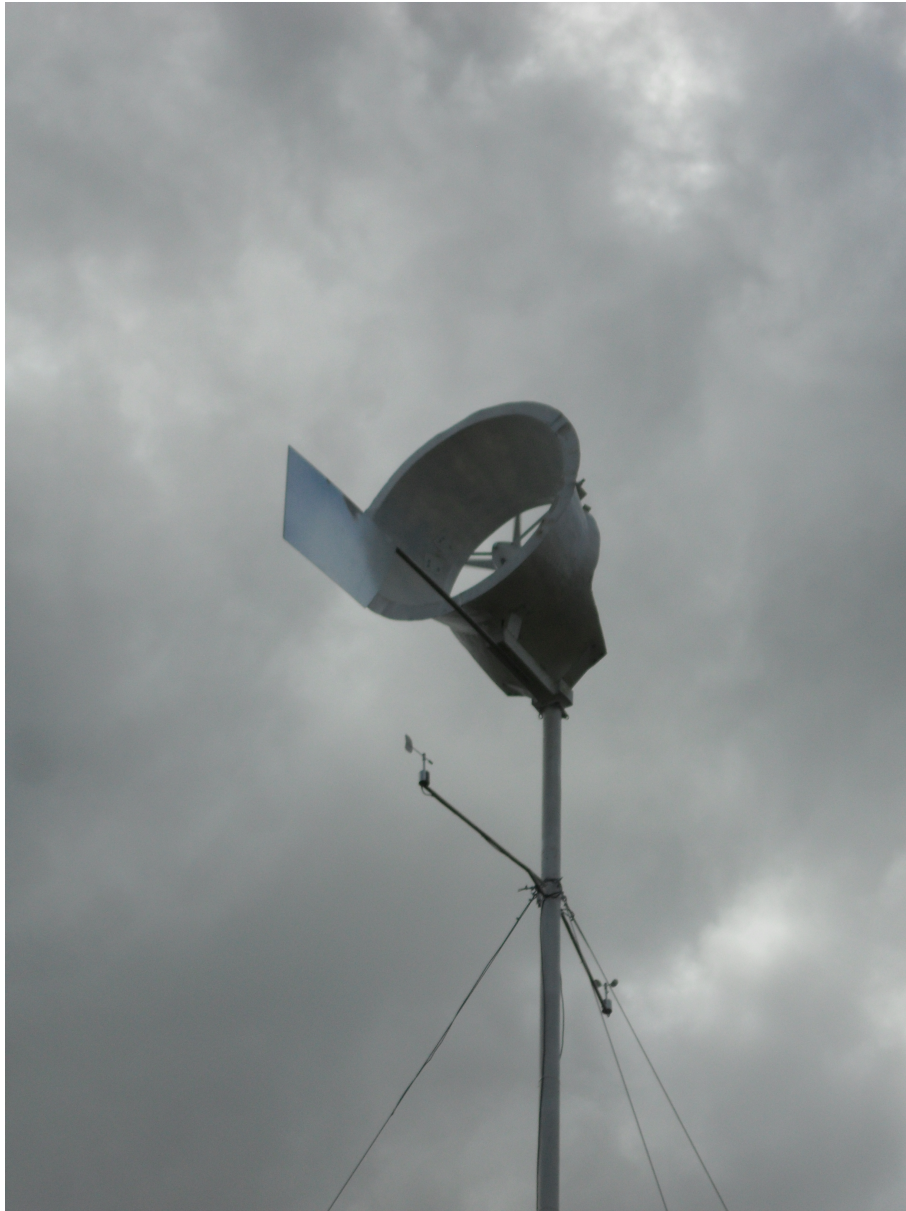
Figura 3.15: Protótipo alterado e com leme colocado
