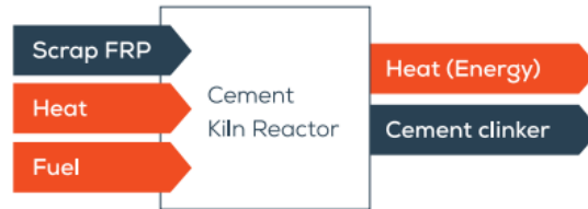
Ilustración 11: Esquema de co-procesamiento del cemento (Fuente: WindEurope, 2020).
