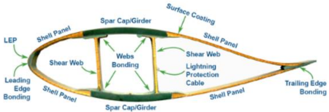
Ilustración 1: Sección transversal genérica de una pala (Fuente: TPI Composites)
