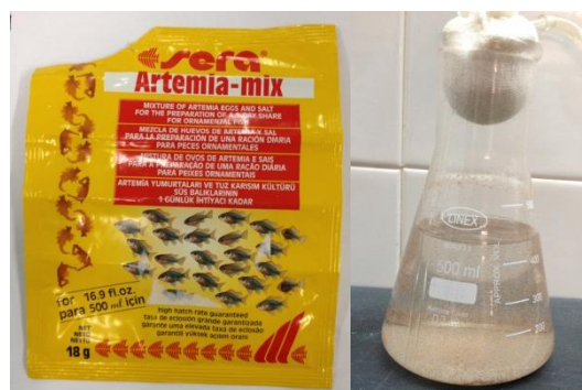
Figura 3.10 – Testes de ecotoxicidade com artémia: a) Aspecto da embalagem comercial utilizada; b) Hidratação dos quistos de artémia.
