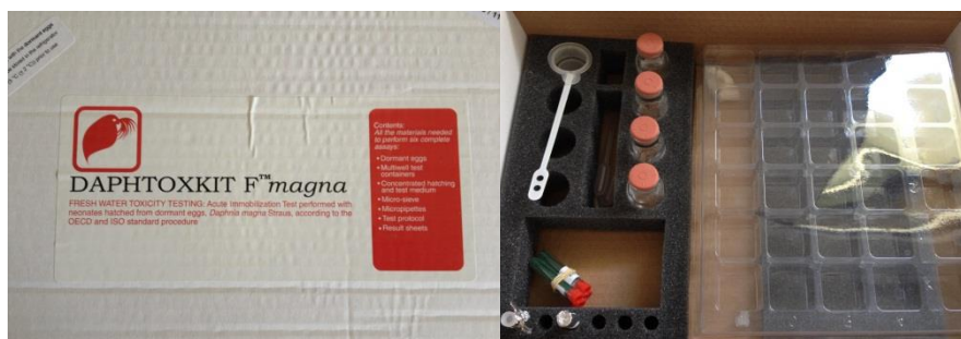
Figura 3.8 – Aspeto dos componentes do kit Daphtoxkit F TM magna : a) Exterior do kit utilizado; b) Interior do kit utilizado.
