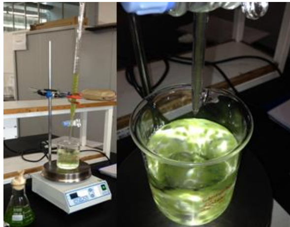
Figura 3.5 – Etapas do processo de imobilização das microalgas: a) Gotejamento da solução de microalgas em alginato de sódio; b) Aspeto das esferas de microalgas em alginato de sódio na solução de cloreto de cálcio.
