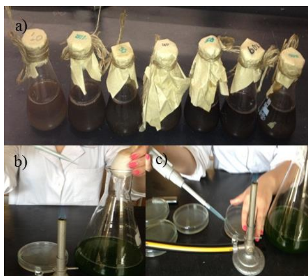
Figura 3.3 – Etapas do screening : a) preparação das diluições de efluente com agar; b) e c) inoculação das placas.
