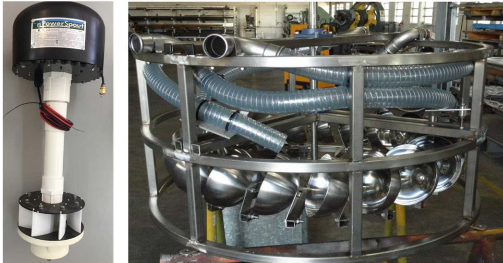
Figura 20: Turbina LH400 e roda de água antes da instalação na Casa da Seda Fonte:[50]
