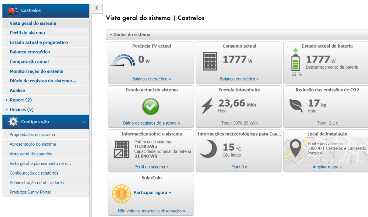
Figura 40: Interface do Sunny Portal para a microrrede do Posto Aquícola de Castrelos Fonte: Sunny Portal
