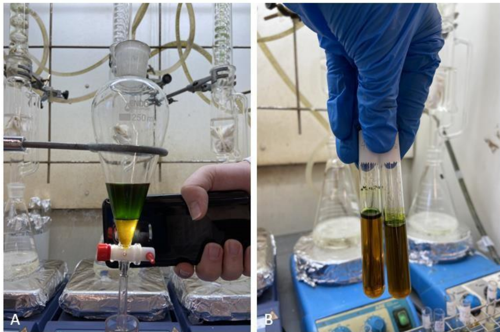
Figura 10 - Procedimento experimental para determinação dos Açúcares – Duas fases aparentes após lavagem com éter dietílico (A), Tubo contendo a primeira fase após separação (B) (Fonte: Ana Luisa Pepinelli, 2022).
