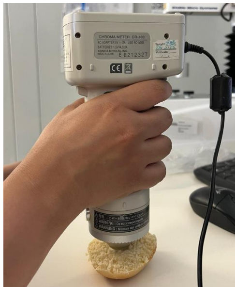
Figura 18 – Equipamento utilizado para medição da cor nas amostras de pão de leite (Fonte: Ana Luisa Pepinelli, 2022).
