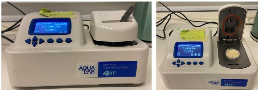
Figura 22 – Medidor de atividade de água (Fonte: Ana Luisa Pepinelli, 2022).
