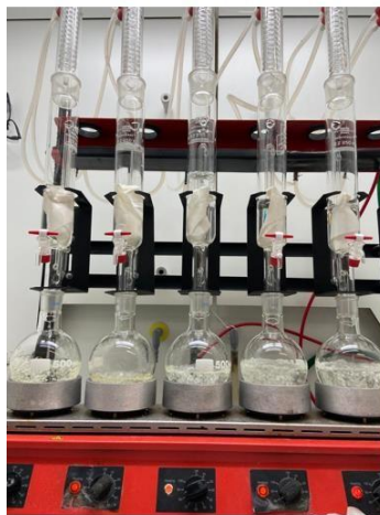
Figura 8 – Equipamento utilizado para a determinação do teor de lipídios (soxhlet) (Fonte: Ana Luisa Pepinelli, 2022).
