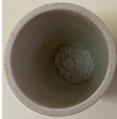
Figura 9 – Amostra após incineração em mufla (Fonte: Ana Luisa Pepinelli, 2022).
