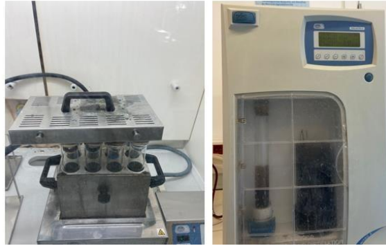
Figura 7 - Equipamentos utilizados para a determinação do teor de proteínas (Fonte: Ana Luisa Pepinelli, 2022).
