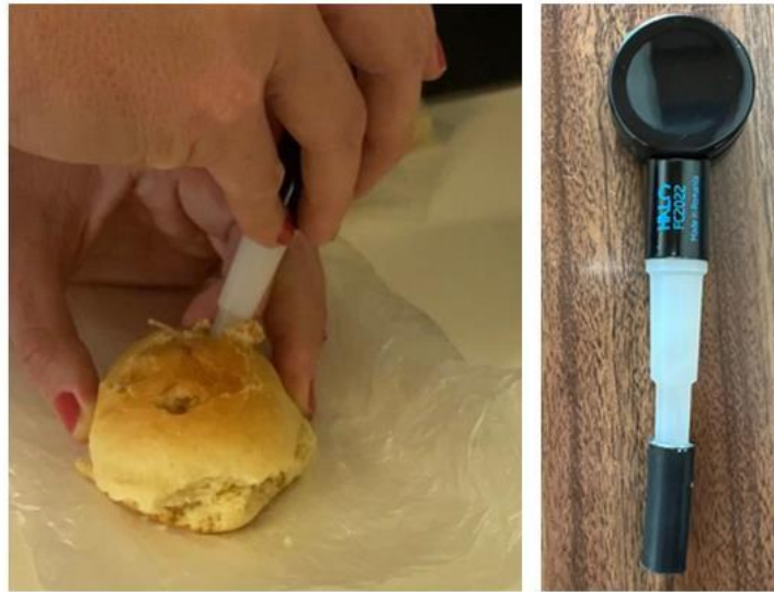
Figura 20 - Medição do pH das amostras (Fonte: Ana Luisa Pepinelli, 2022).
